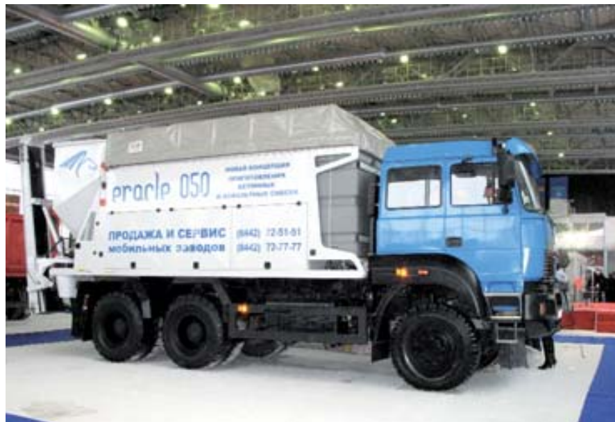
Мобильный завод Eracle 050, предлагаемый компанией «Тези-ТГ инвест»
